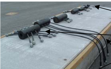
Rak koppling X-koppling med brottlast på 198 ton L-koppling
